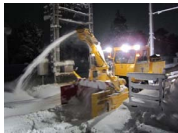
軌陸車 (除雪中)
